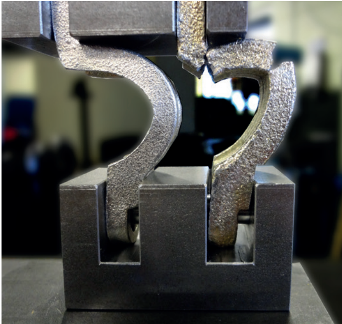
Bruchversuch - links: LUDECKE Schlauchklemme (kein Riss/ Bruch), rechts: Schlauchklemme aus Fernost (Komplettbruch)
